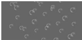
ウルトラファインバブル (数十nm～1μm未満)
